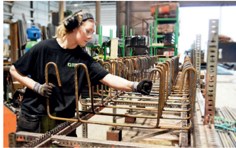
Les étriers pour les poutres sont positionnés sur la grille du système SKEW JIG.
